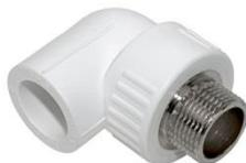
Уголок 90° комбинированный с наружной резьбой даст возможность соединить пп трубу с уже имевшейся в наличии стальной частью трубопровода, а также со специальной арматурой запорной. Он позволяет сделать монтаж под прямым углом.
