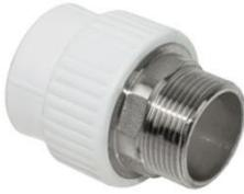
Комбинированная муфта из ПП имеет наружную резьбу, позволяющую сборку стандартным ключом. Она очень удобна, когда требуется быстро собрать прокладываемый ПП трубопровод, например, с проложенной ранее в помещении стальной трубой или различной необходимой запорной арматурой. Сделать это легко позволяет трубная наружная резьба.
