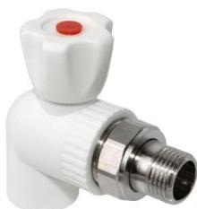
Радиаторный кран имеет полипропиленовый корпус. Предназначен для монтажа в углу. Кран радиаторный угловой понадобится для того, чтобы подключить радиатор отопительный к нужной разводке, сделанной из полипропиленовых труб. Он позволит перекрыть поступление теплой или горячей воды, необходимой для работы отопительного прибора.
