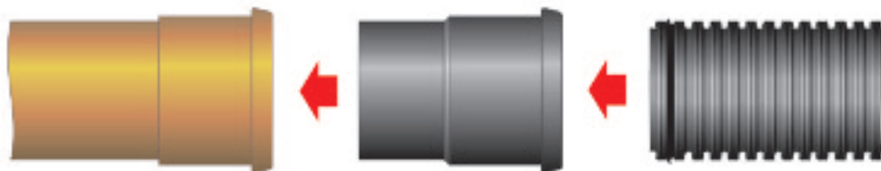
Рис. 16. Соединение труб КОРСИС (гладкий конец) с трубами из ПВХ/ПП
